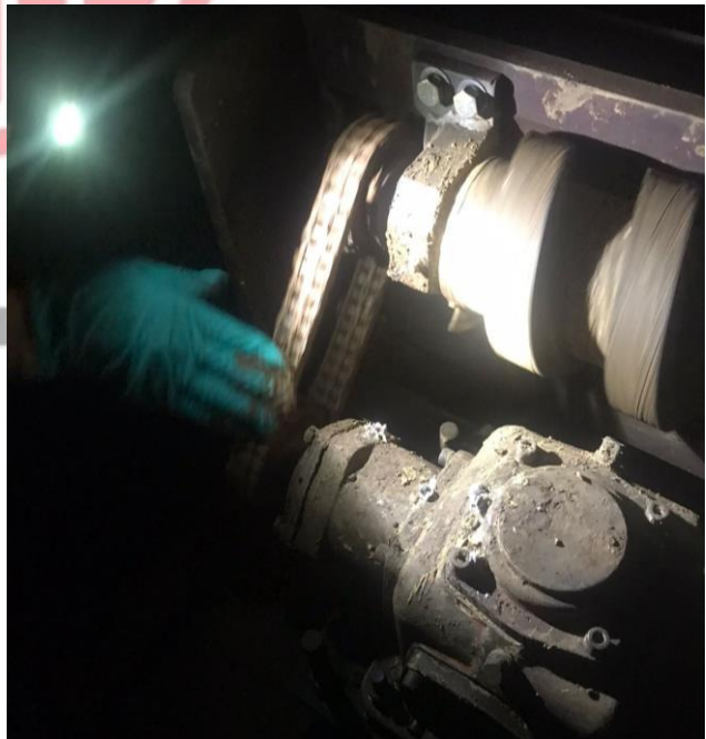
Figure 23 : Graissage de la chaîne de transmission
