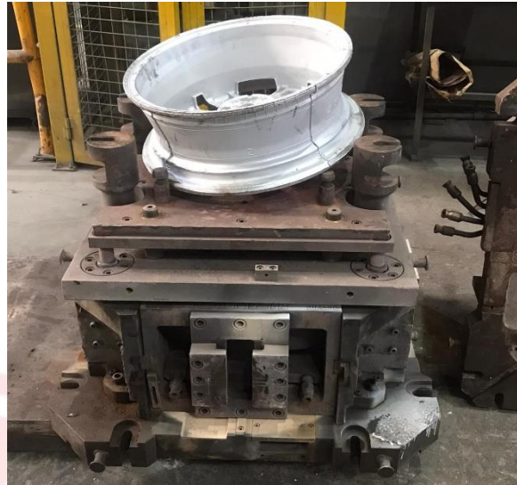
Figure 18 : Moule démonté avec la jante NOK
