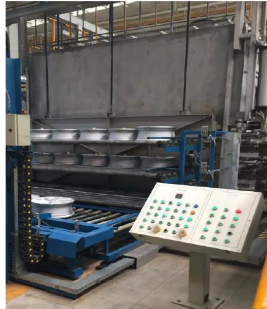
Figure 24 : Jantes prêtes à entrer au 1 er four de chauffage
