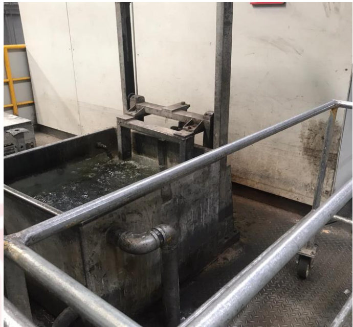
Figure 30 : Différence d'hauteur entre un chariot et le bassin
